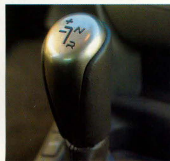
Links: De 17-inch wielen zijn een optie. Midden: De witte wijzerplaten geven het strakke dashboard een sportief accent. Rechts: Met de joystick-achtige pook kan de sequentiële vijfbak worden bediend.
